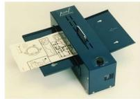
Fornetto per la creazione di materiale in rilievo su carta speciale. Basta predisporre il disegno su una carta speciale chiamata swell o stereocopy, utilizzando fotocopie, stampa diretta da pc con stampante a getto di inchiostro HP, disegnare con speciali pennarelli a basso contenuto di alcol, disegnare a matita e far passare il foglio su questo fornetto per ottenere il disegno in rilievo.
