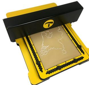
MDA (Motorized Drawing Arm) di Thinkable è un plotter che riproduce sui fogli di plastica con il piano gomma Tactipad, la grafica in rilievo, realizzata mediante uno smartphone, tablet o computer.
